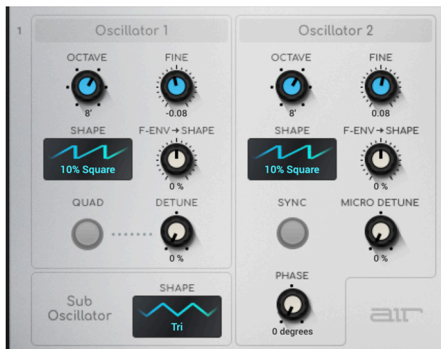
▲ 両オシレーターで矩形波寄りのノコギリ波を選択 Fine つまみでオシレーター 1 をデチューン
